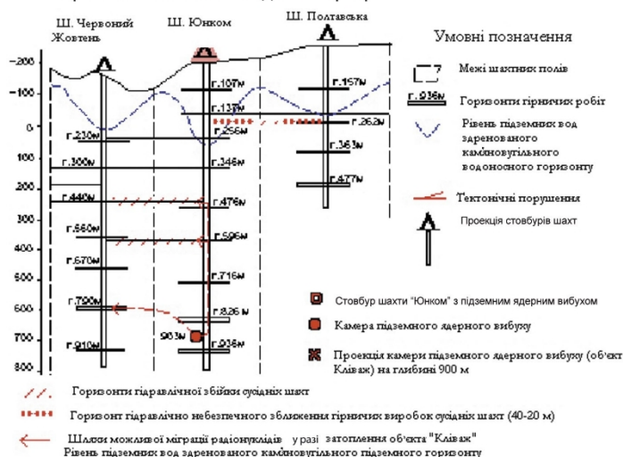
Abb. 1. Struktur- und Hydrogeofiltrationsschema zur Flutung der nuklearen Explosionskammer der Mine Yunkom (Region Zentral-Donbas)
