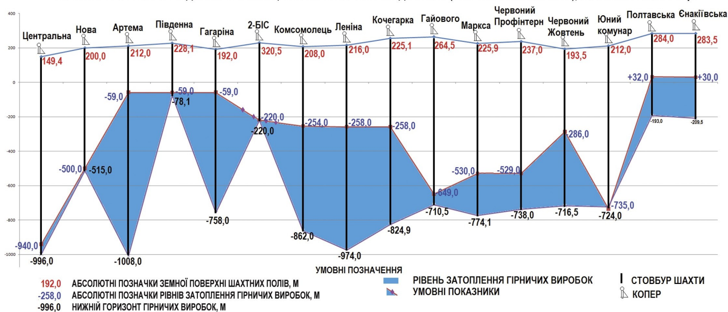
Abb. 2. Schematischer struktureller und hydrogeologischer Schnitt durch den südlichen Flügel der Region Zentral-Donbas (Stand: 1.11.2017)
